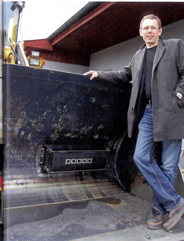
– I oktober beräknas försäljningen av dg precision feeding starta, säger Magnus Palmgård. NIR-instrumentet monteras i skopan.
